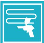
Deux couches complètes avec évaporation. Pistolet à peinture\*. Ouverture de la buse par méthode pneumatique : **1,3 - 1,4 mm**.
