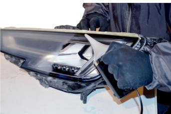
6. Beginnen Sie 1 cm vom Scheinwerfer entfernt mit dem Dampfen und tragen Sie es von der Flasche nach oben auf, bis der Scheinwerfer hell wird. Achten Sie darauf, dass die Lippenöffnung nach oben zeigt, damit sich der Dampf nicht in Wassertropfen verwandelt. Halten Sie Ihr Gesicht mindestens 40 cm von der Öffnung des Deckels entfernt.
