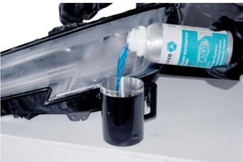
4. Scheinwerfer-Renovierungspolymer bis zur Hälfte des Verdampfers einfüllen und mit dem Deckel abdecken, der am besten zur Form des Scheinwerfers passt.
