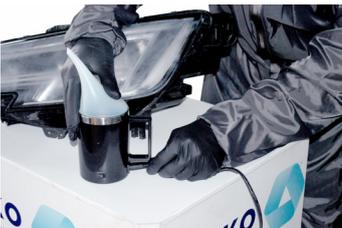
5. Anschließen und etwa 5-6 Minuten lang erhitzen, bis Dampf austritt. Lassen Sie ihn nicht länger als 20 Minuten angeschlossen.
