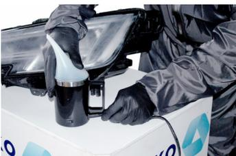
5. Connecter et chauffer pendant environ 5-6 minutes jusqu'à ce qu'il y ait de la vapeur qui se dégage. Ne pas laisser connecté plus de 20 minutes.
