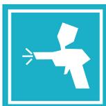
Mit einer Spritzpistole für dicke Massen mit Düsendurchmesser auftragen 4 mm bei einem Luftdruck von 2 - 4 bar aus einem Abstand von ca. 15 - 20 cm. Anzahl der Schichten: 1 - 2.
